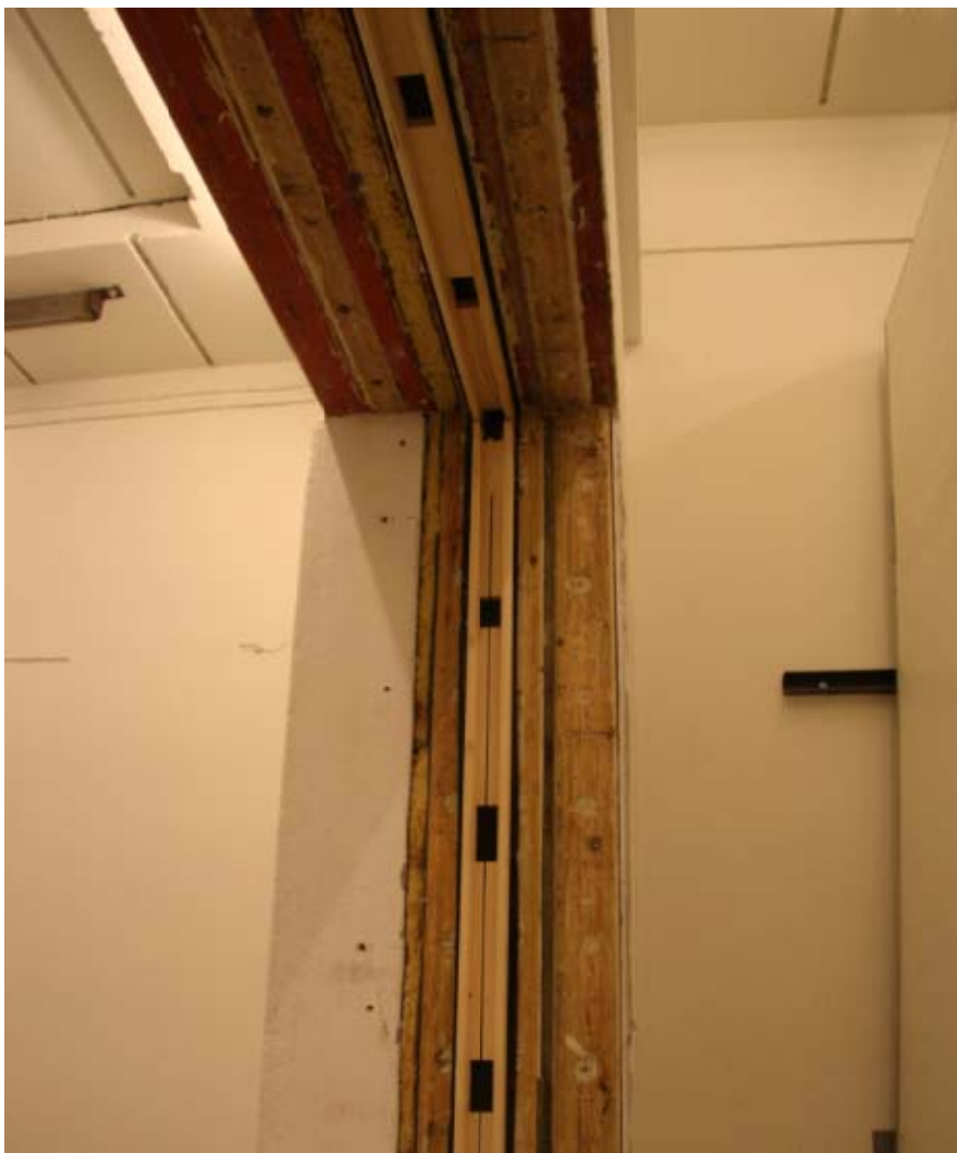
Bild 4 – EPDM-list fästes mot provöppningen och därefter reglar och skenor.
